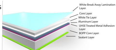
ONE SIDE HEAT SEALABLE, ONE SIDE EXTRUSION COATED WITH WHITE BREAK AWAY LAYER
